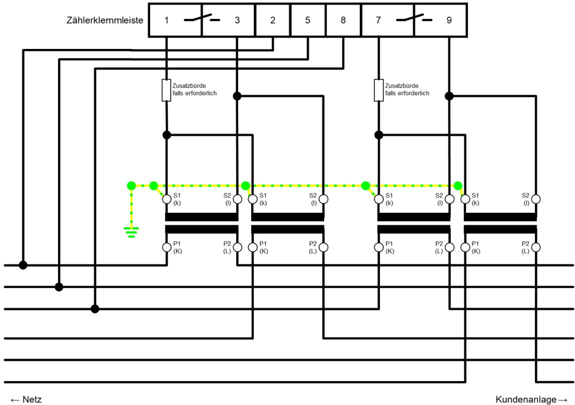
**Abbildung 10: Verdrahtung 500 V Wandlermessung für redundanten Netzanschluss NS/N**
