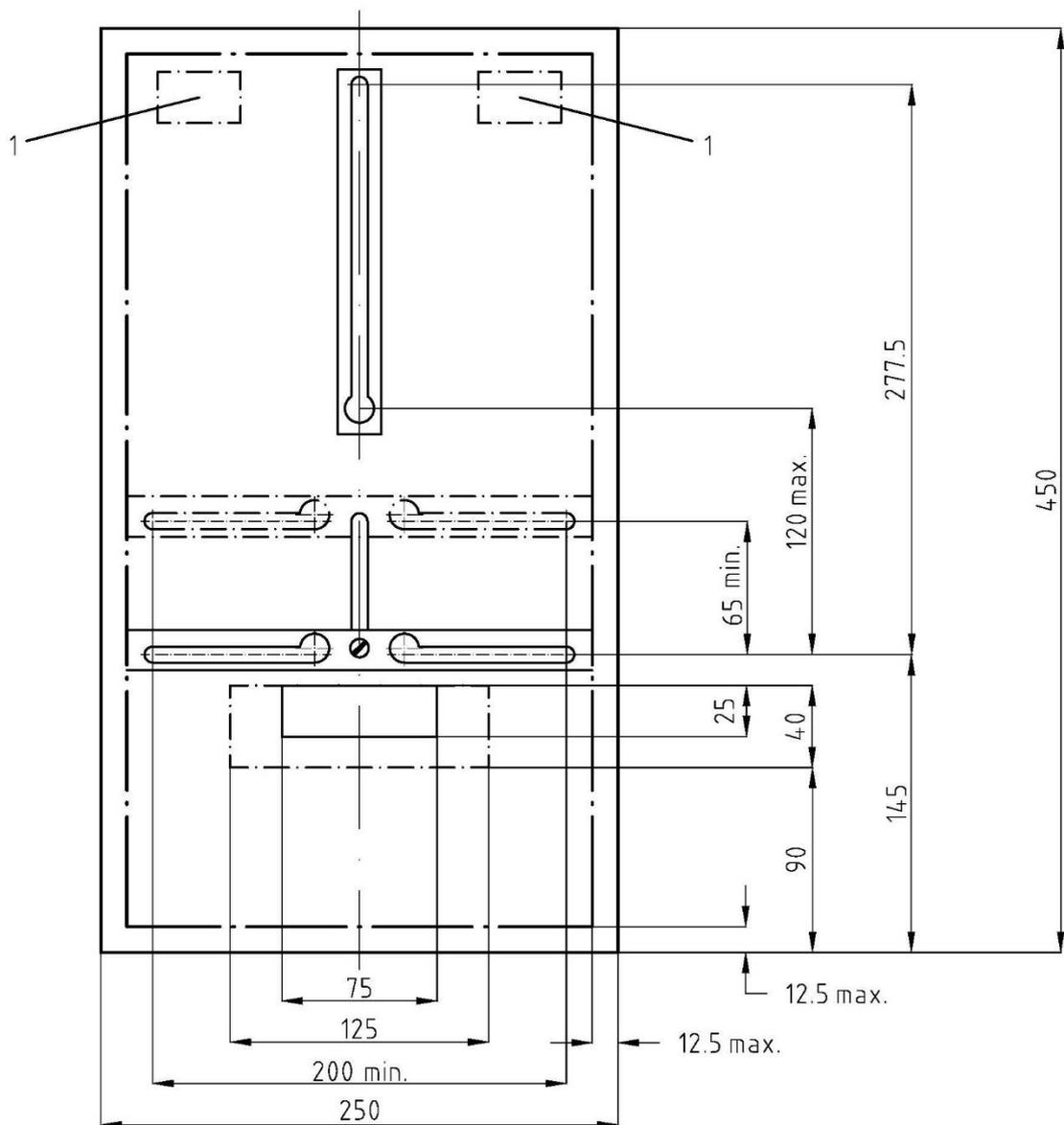
**Abbildung 7: Abmessungen des Zählerfelds**
